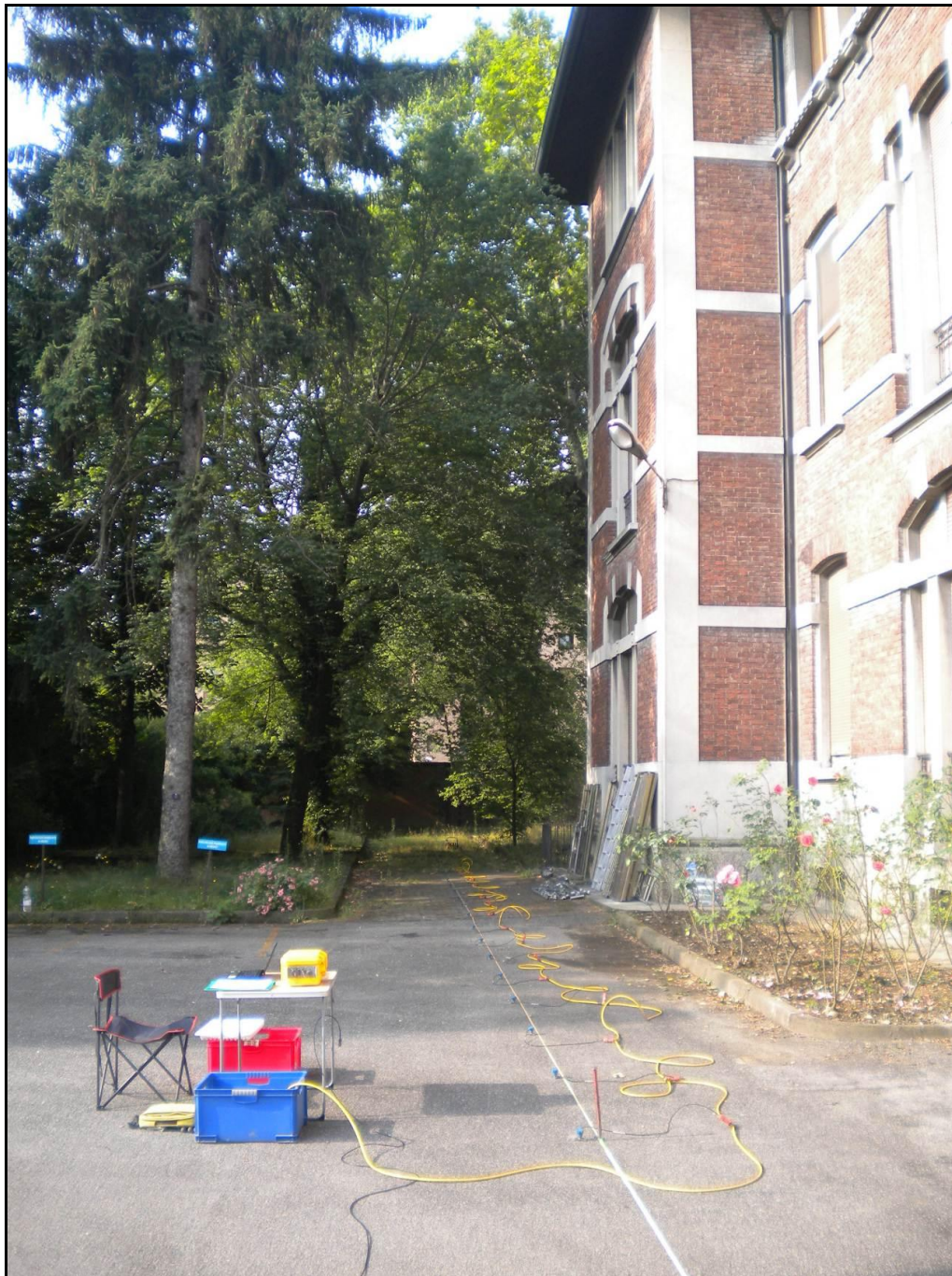
Figura 3: Vista dello stendimento MASW effettuato.
